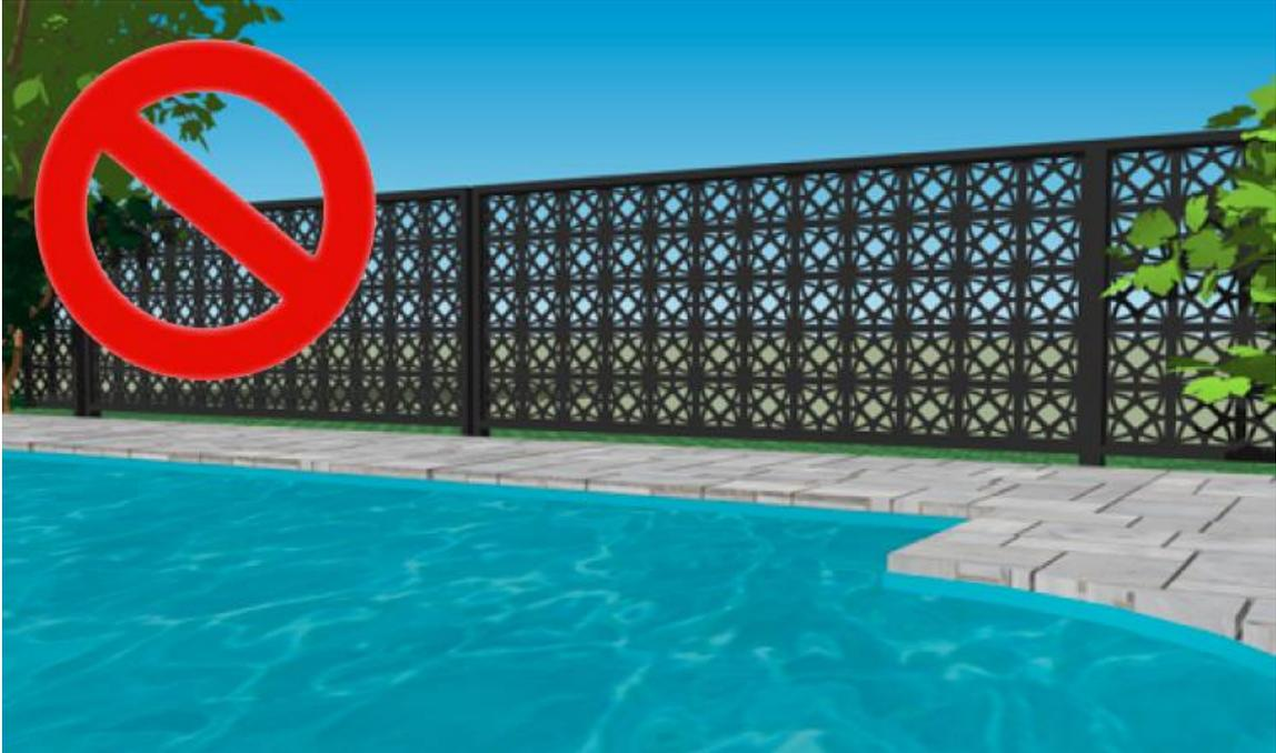
La clôture ne doit pas avoir d'éléments facilitant l'escalade de l'enceinte (par exemple : planches horizontales, fer forgé ornemental, mailles de chaîne de plus de 30 mm sans lattes).
