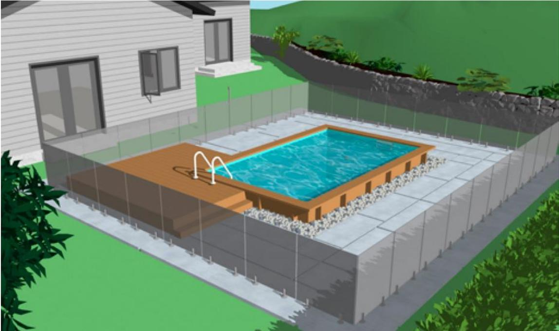
L'enceinte doit également être à plus de 1 m d'une fenêtre pouvant s'ouvrir de plus de 10 cm ou à moins de 3 m du sol. Cette mesure vise à éviter qu'un enfant accède à la piscine par une fenêtre.
