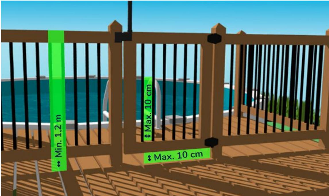
Les piscines creusées, semi-creusées, hors terre avec une paroi de moins de 1,2 m et les piscines démontables dont la paroi est moins de 1,4 m doivent être munies d'une enceinte respectant les dimensions illustrées sur l'image.
