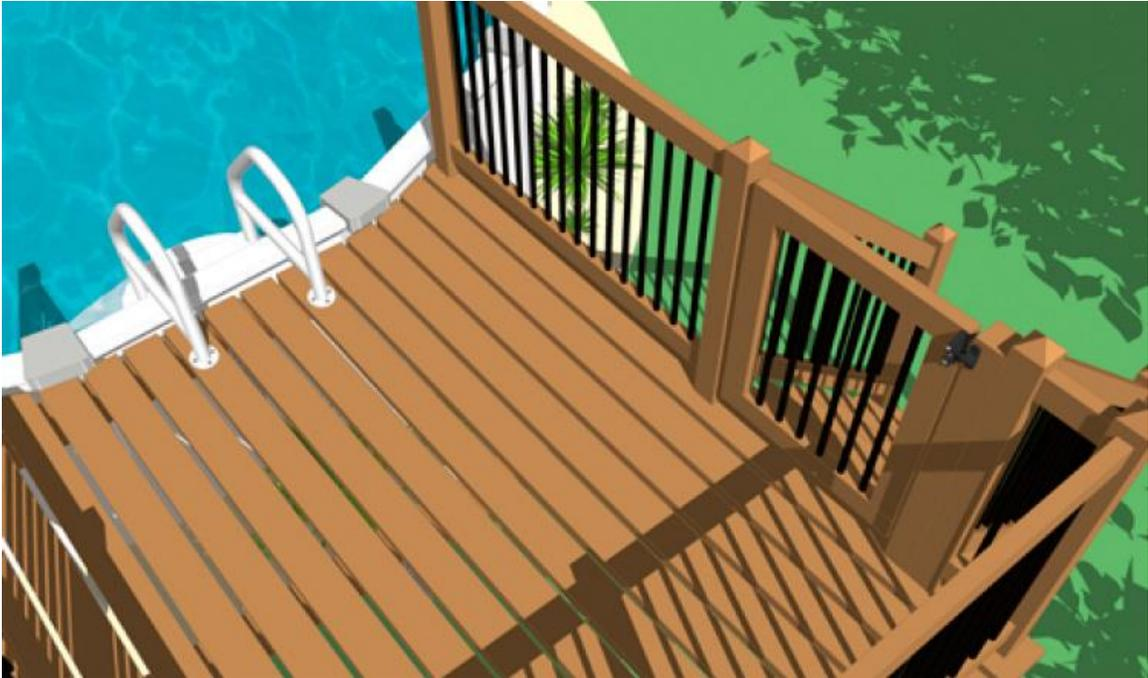
L'enceinte doit être munie d'une porte avec les mêmes restrictions, en plus d'avoir un système de fermeture et de barrure automatique.
